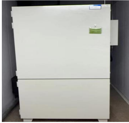
拣选工序滤筒除尘器
